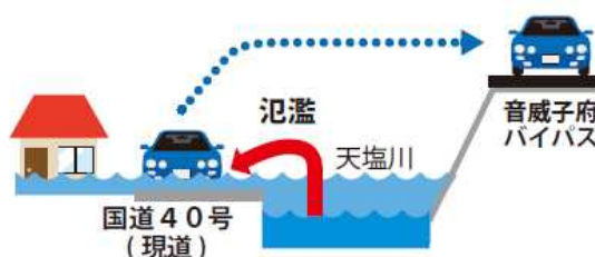
図 3-44 道路の高台整備による被災回避効果イメージ
