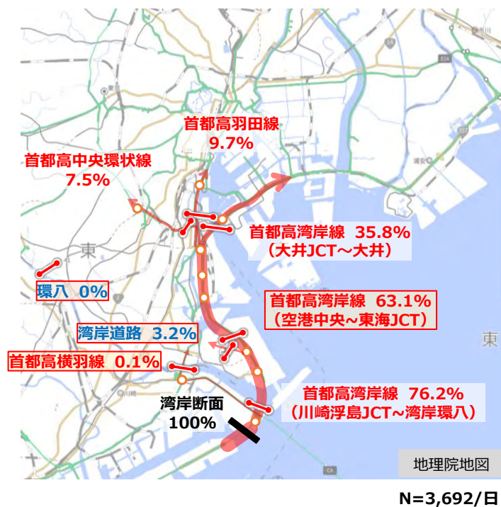
図 2-208 首都高湾岸の交通流動(通常時)
