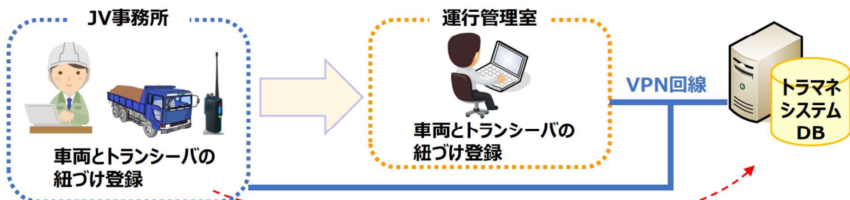
図 2-14 VPN 回線を JV 事務所に導入し JV 事務所で行う案
