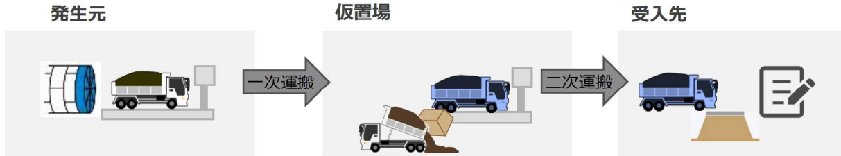
図 2-11 大泉 JCT にて行っている GPS を活用せずに運搬実績を記録する方法（現行）
