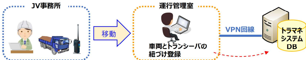
図 2-13 車両と GPS トランシーバの紐づけ作業を運行管理室で行う現行案
