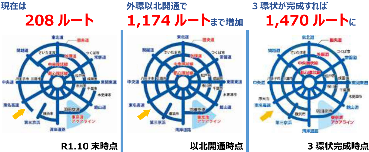
図 4-65 三環状道路の整備によるリダンダンシーの強化 （東名から東京都心へ至るパターン(試算)）
