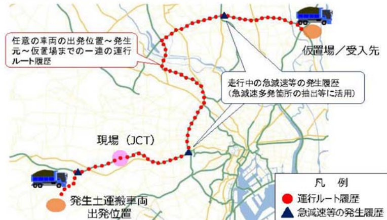
図 21 ETC2.0 を活用した工事車両運行実績管理の運用イメージ
