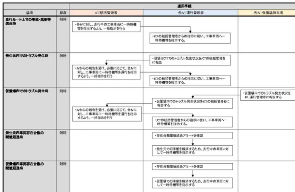
突発事象発生時の運用フロー
