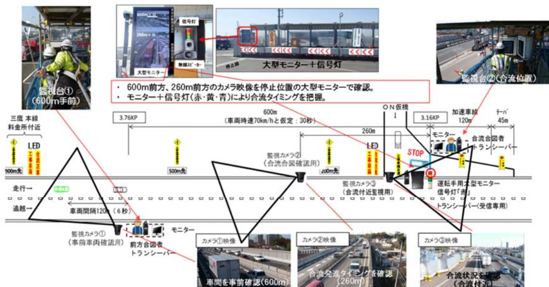
図 3-48 誘導員による合流支援方法の概要
