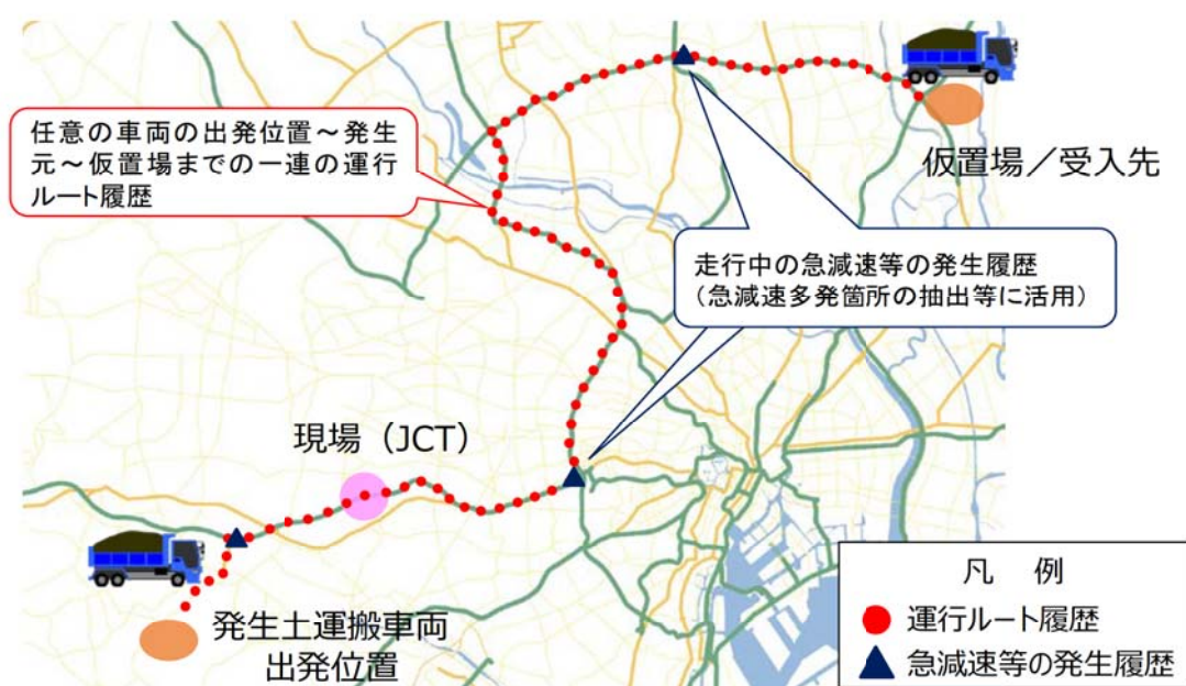
図 3-65 ETC2.0 を活用した工事車両運行実績管理の運用イメージ
