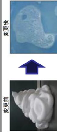
※起泡溶液が増加する事に伴い、土砂搬出可能な性状を確保するため、中性固化材等の添加材を増加。
